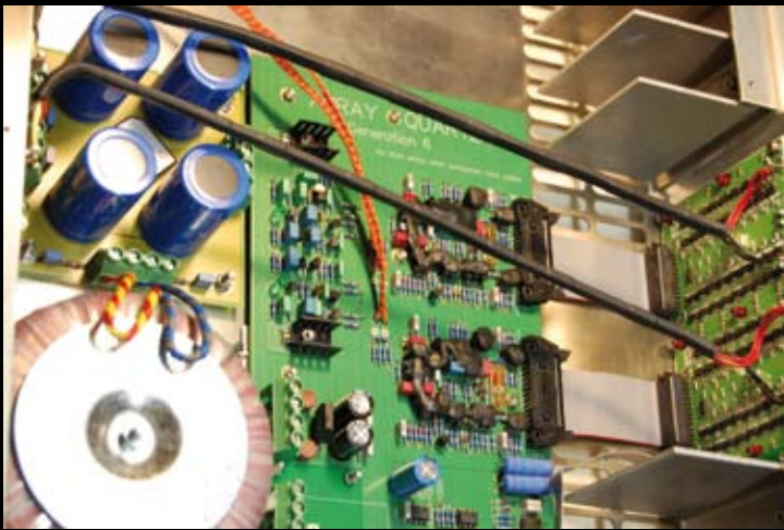
De eindtrappen worden aangestuurd vanuit volledig discreet opgebouwde klasse A stuurversterkers. Bij onze demomodel waren de transistoren nog niet vastgekit.
